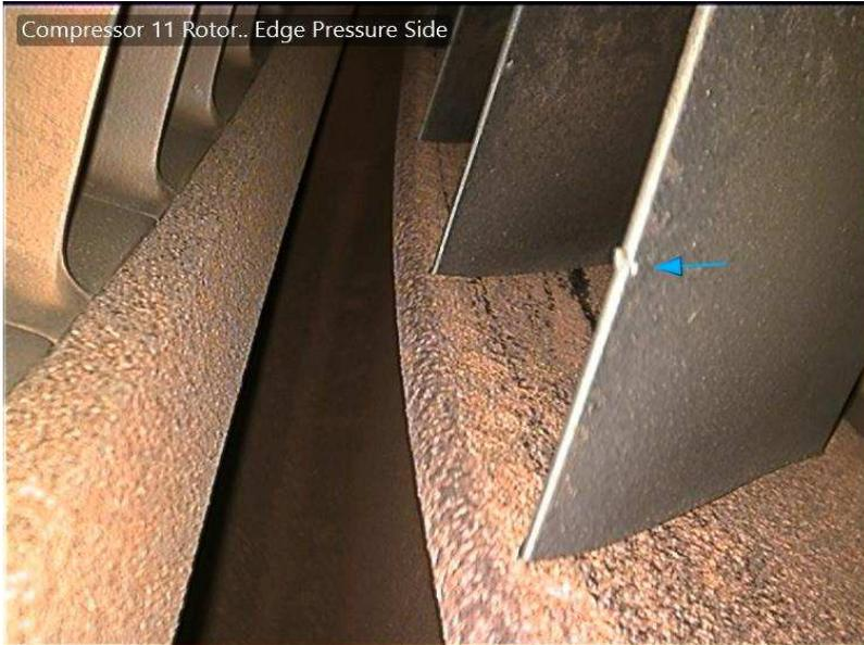
Compressor 11 Rotor.. Edge Pressure Side
