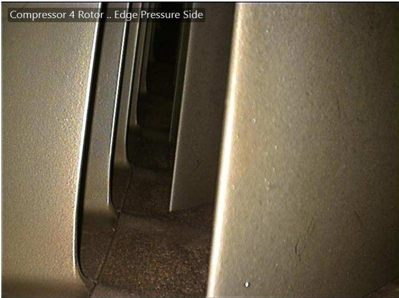
Compressor 4 Rotor .. Edge Pressure Side
